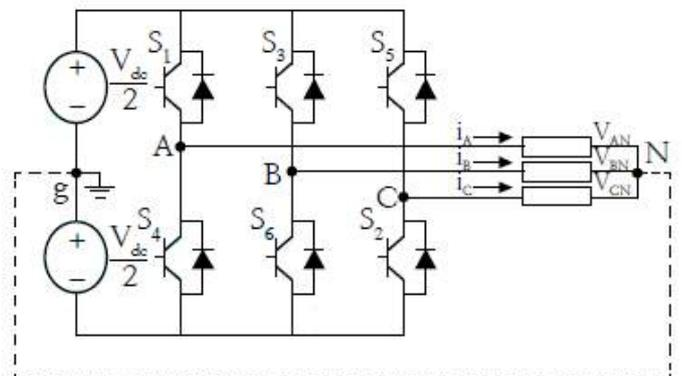
①  $V_{AN} = \frac{V_{dc}}{2}, V_{BN} = \frac{V_{dc}}{2}, V_{CN} = \frac{V_{dc}}{2}$
