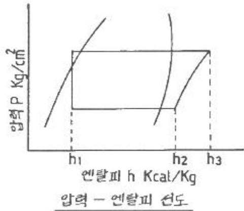
$$\text{cop} = \frac{h_2 - h_1}{h_3 - h_2}$$
