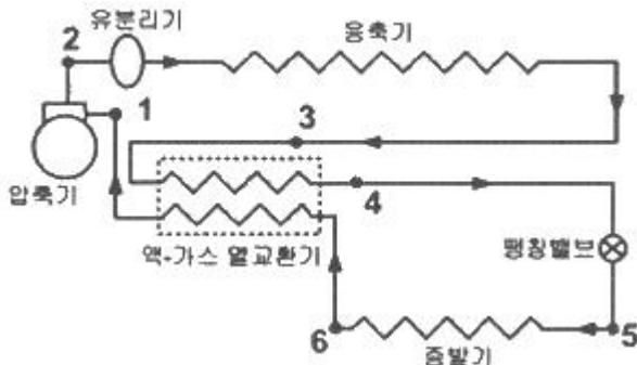
액-가스 열교환기에서 응축기 출구 냉매액과 증발기 출구 냉매증기가 서로 열교환할 때, 이 열교환기 내에서 증발기 출구 냉매 온도변화( $T_1 - T_6$ )는  $18^{\circ}\text{C}$ 이고, 응축기 출구 냉매액의 온도 변화( $T_3 - T_4$ )는  $1^{\circ}\text{C}$ 이다.
