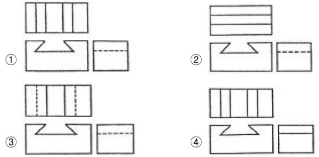
59. KS에서 규정하는 체결부품의 조립 간략 표시방법에서 구멍에 끼워 맞추기 위한 구멍, 볼트, 리벳의 기호 표시 중 공장에서 드릴 가공 및 끼워 맞춤을 하는 것은?
