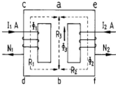
①  $\frac{N_2 I_2 - N_1 I_1}{R_1 + R_2 + R_3}$       ②  $\frac{(N_2 I_2 - N_1 I_1) R_3}{R_1 R_2 R_3}$
