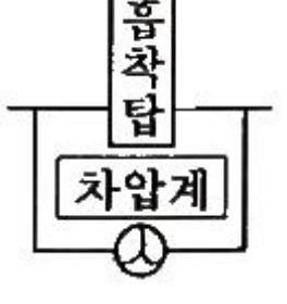
72. 직경 150mm 인 덕트 내 정압은 -64.5 mmH<sub>2</sub>O이고, 전압은 -31.5 mmH<sub>2</sub>O 이다. 이 때 덕트 내의 공기속도(m/s)는 약 얼마인가?
